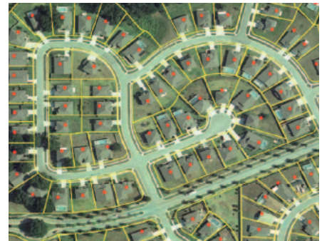
Abb.: Adresspunktgenaue Geokodierung
